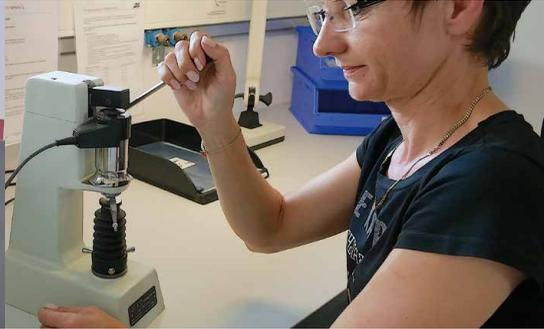
Härteprüfung nach Rockwell | Rockwell hardness test
