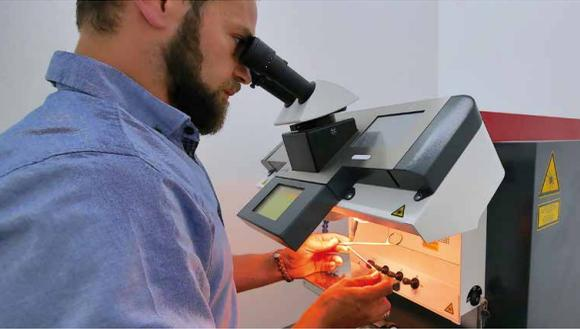
Laserschweißen | Laser welding
